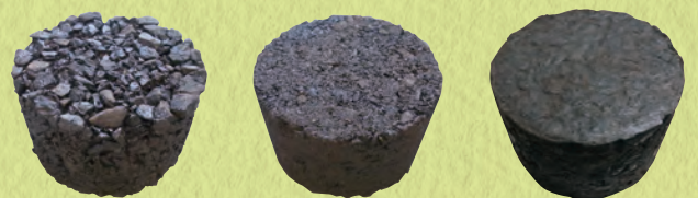
油浸漬後(48時間)の供試体
