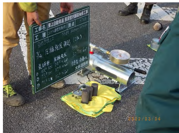
写真-5 ポータブル圧縮試験機による圧縮試験
