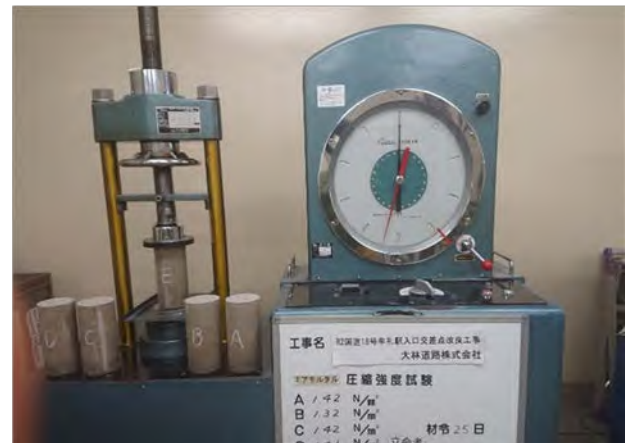
写真-13 一軸圧縮試験状況
