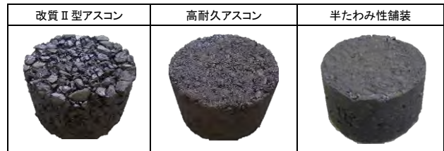
写真-2 耐油性試験後の供試体外観
