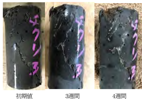
写真-2 表面部の自己治癒状況
