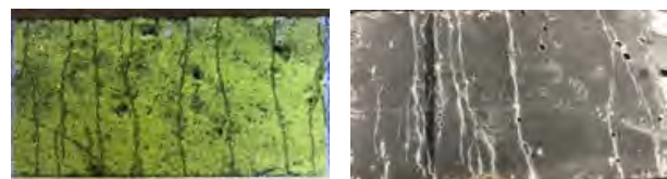
写真-11 18および20N/mm 2 480万回载荷後の底面の状況
