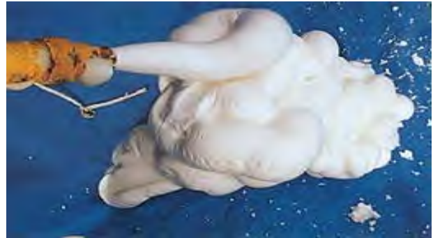
写真-1 FCB工法に用いる気泡 (FCB研究会ホームページ)
