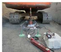
写真 4 平板載荷試験状況
