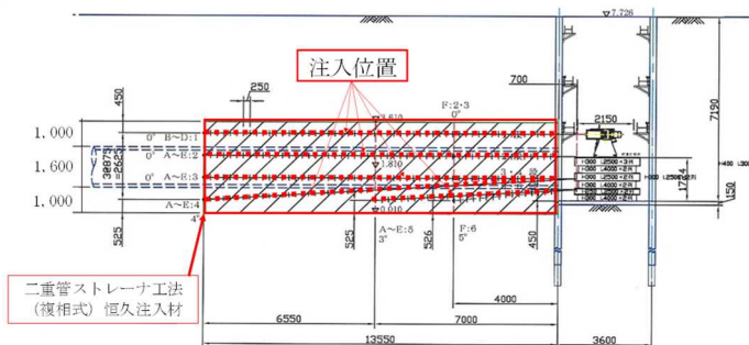
図-3 到達立坑側の路線防護注入計画図
