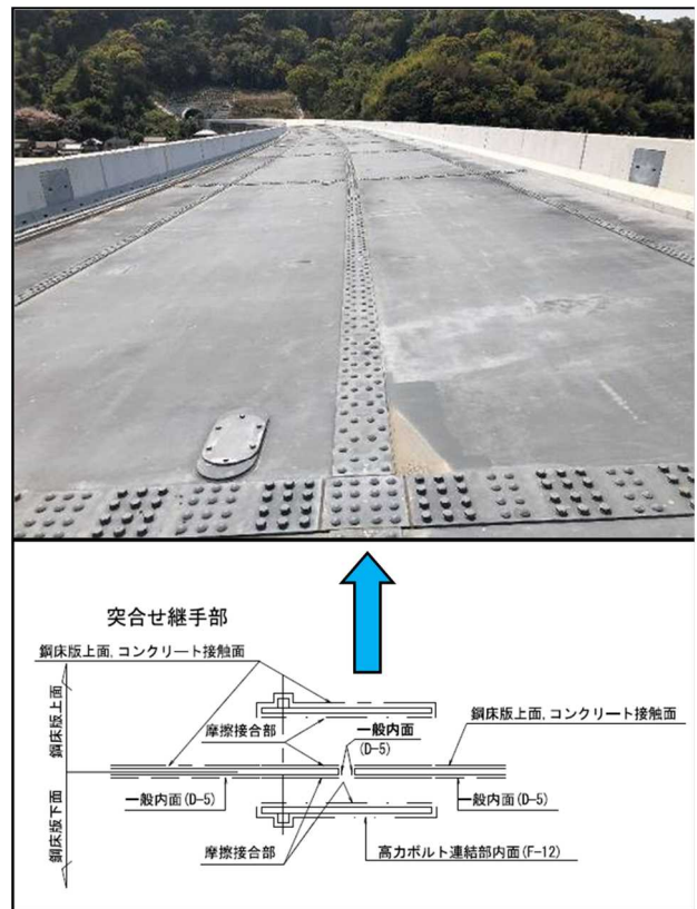
図-3 鋼床版の突合せ継手
