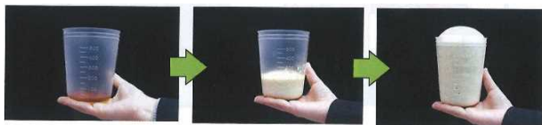
写真-1 硬質発泡ウレタンの反応状況
