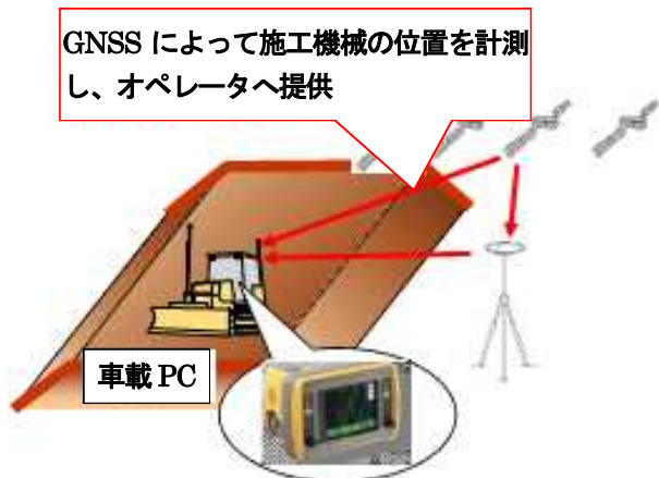
図-3 ICTブルドーザによる施工イメージ
