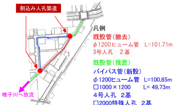
図-2 管路概略平面図
