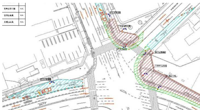
図-3 歩道施工時の規制平面
