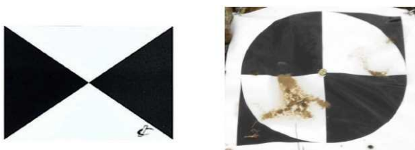
写真-1 起工測量標定点
