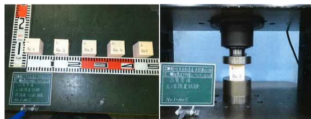
写真-9 供試体と一軸圧縮試験状況
