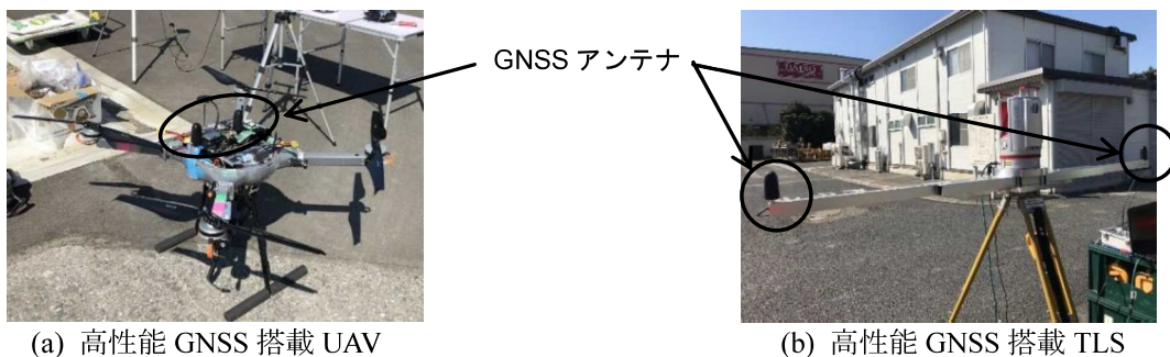
図-2 高性能 GNSS を搭載した計測機器
