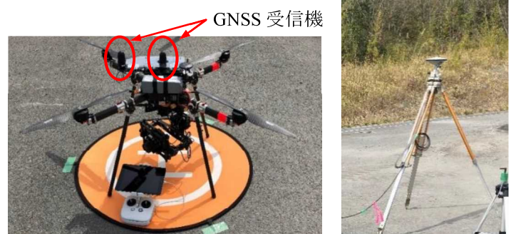
高性能 GNSS 搭載 UAV
