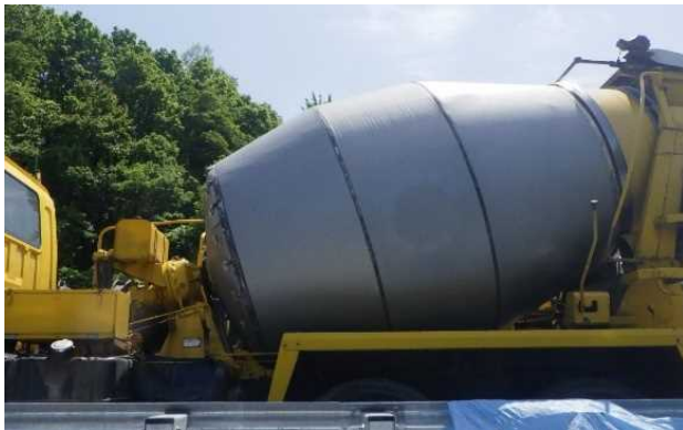
写真-3 アジテータ車のドラム保護カバー
