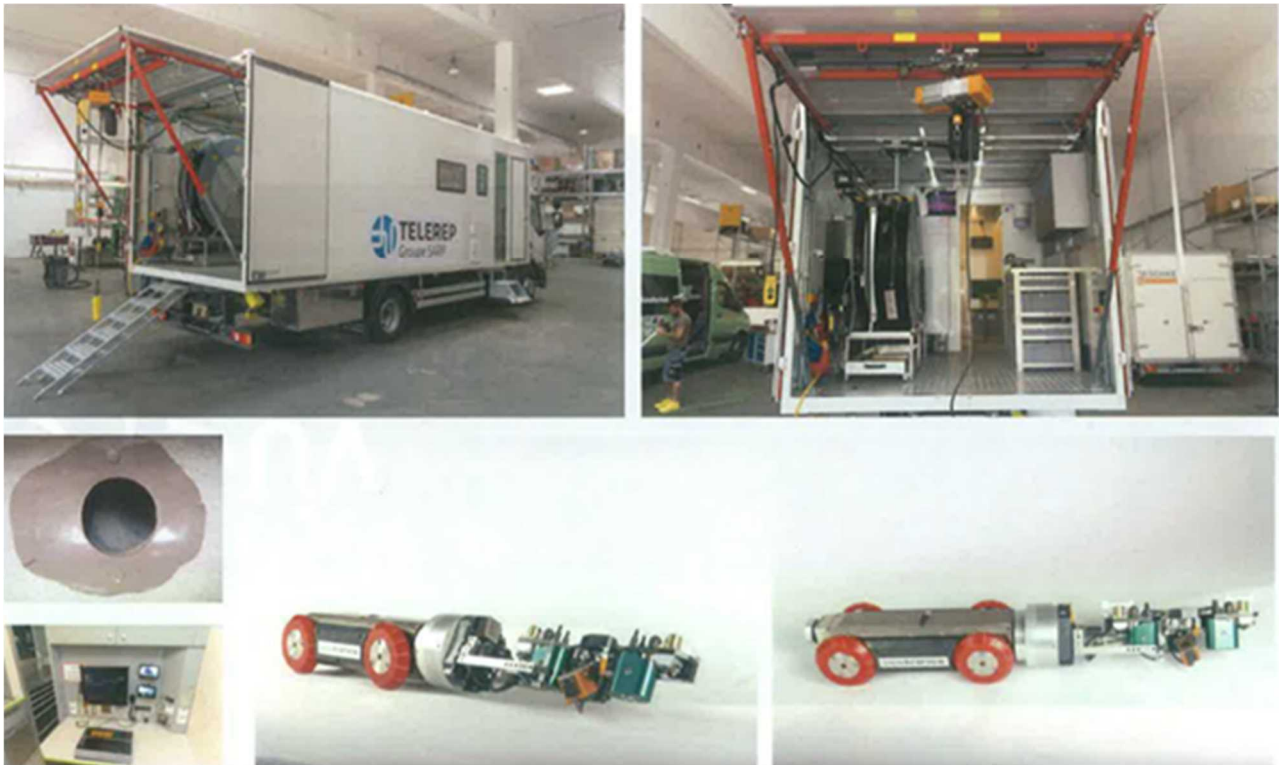
写真-1 光硬化施工車・削孔機
