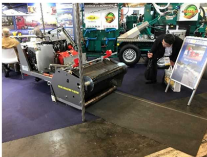
写真-26 防水シート張付け機械
