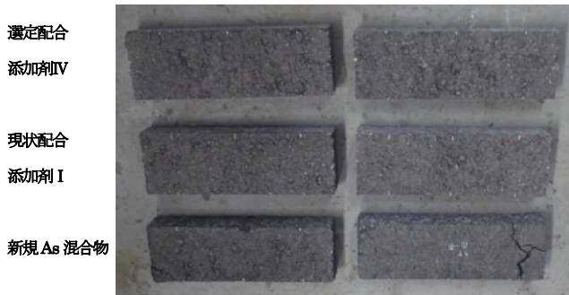
写真-5.3 耐候性試験 1 年経過後の状況
