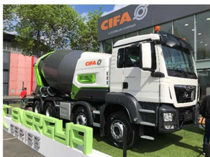
写真-11 セミEVアジテータ(8m 3 )
