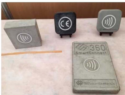
写真-4 NFC 内蔵コンクリート
