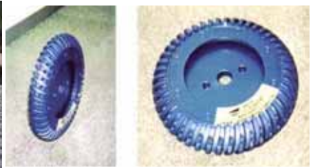
写真-3 融雪溝切削用ブレード
