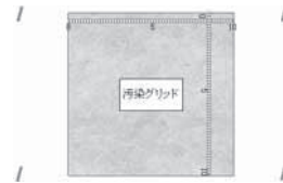
図-13 撤去幅の測定
