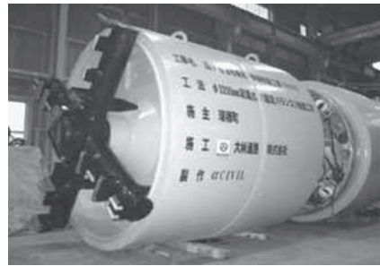
写真-1 泥濃式（超流バランス式）掘進機
