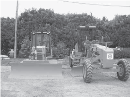
写真-4 TSシステムを装備したモータグレーダとブルドーザ
