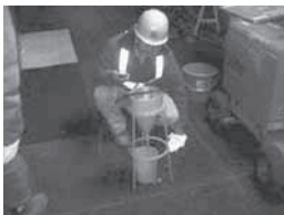
写真-5 フロー試験状況
