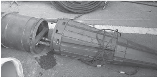
写真-2 先導体とスライド筒 (先導体はEXP-250V)
