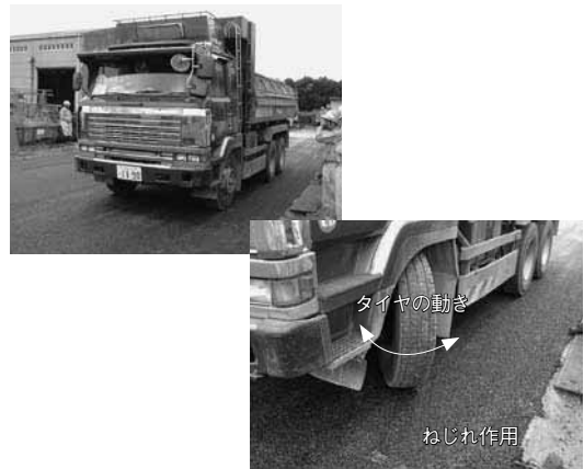
写真-5 大型車によるねじれ試験
