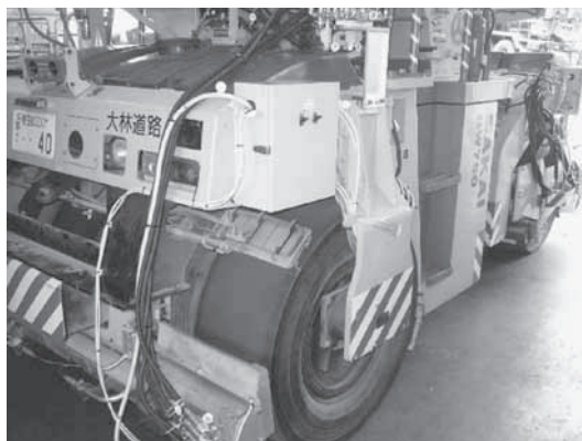
写真-4 タイヤ加熱装置実機完成写真
