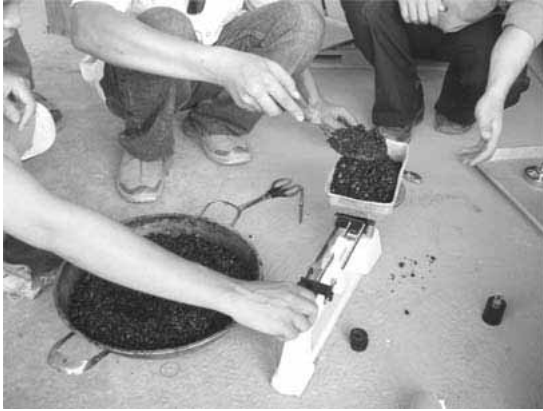
写真-5 分銅を使用した供試体計量状況
