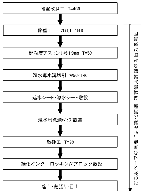
図-3 施工フローチャート
