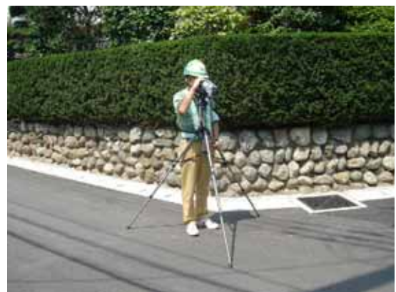
写真-4 熱画像撮影状況
