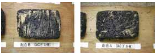
写真-1 バット法によるダレの比較
