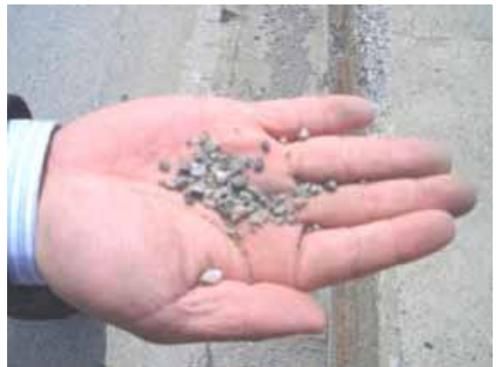
写真-5 管理用道路 滑り止用散布骨材
