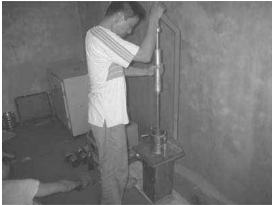
写真-6 人力による供試体作製状況
