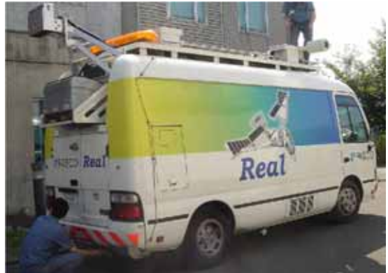
写真-1 路面性状測定車 (real)
