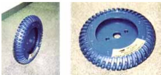
写真-3 融雪溝切削用ブレード
