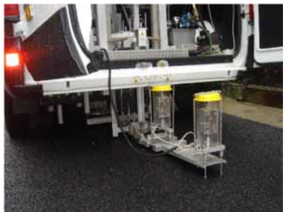
写真-3 FWD測定状況 (上: 全景, 下: センサ部)
