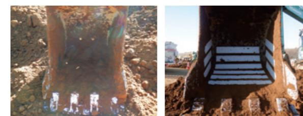
(左) 対策を施していないバケットでは、50kg程度の残土が付着 (右) 対策をしたバケットでは7kg程度(7割減)に減少
