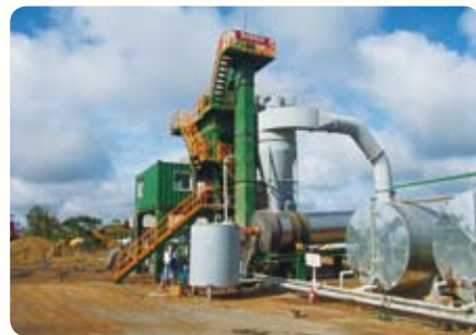
アスファルトプラント
