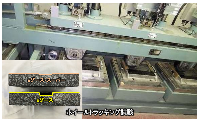
図4 塑性変形抵抗性の評価
