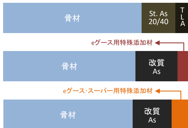
図3 混合物の配合 (上:従来のグースAs, 中:eグース, 下:eグース・スーパー)
