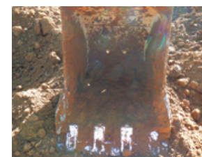
(左) 対策を施していないバケットでは、50kg程度の残土が付着
