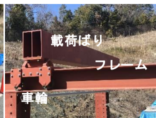
図6 反力装置(詳細)
