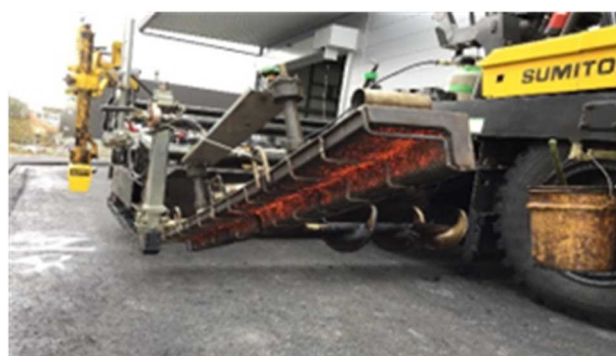
写真-4 L型ジョイントヒータ
