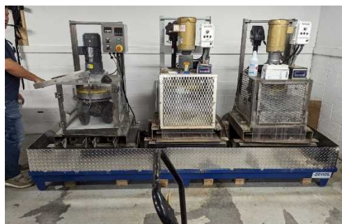
写真-8 ねじり抵抗性試験機
