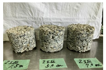
写真-10 P の切り取り供試体
