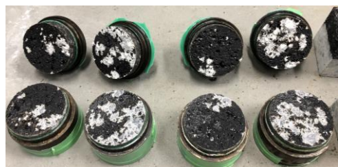
図－3 プライマ B 引張試験後
