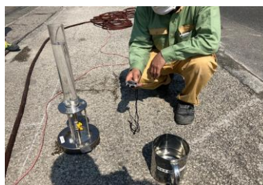
写真-9 現場透水試験
