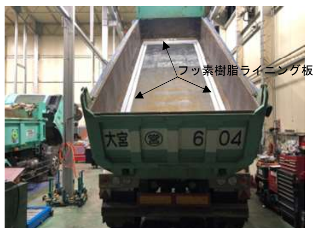
写真-3 フッ素樹脂ライニング板の取り付け位置
