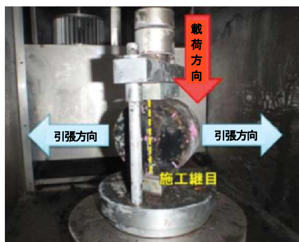
写真-2 圧裂試験状況
