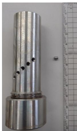
写真 - 1 筒状浸透試験器
