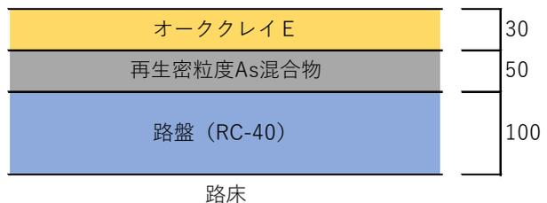
図-2 オーククレーEの舗装断面
