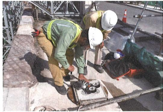
写真-11 引張接着強度試験
