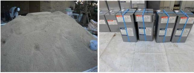
写真-1 使用材料(左：真砂土、右：エポキシ樹脂)
