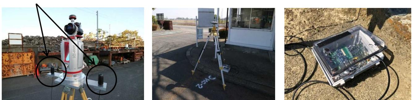
(a) 高性能 GNSS 搭載 TLS
