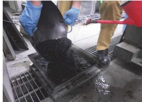
写真-2 中和反応型常温の供試体作製状況
