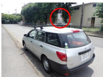
図-2 車両に搭載した TLS
