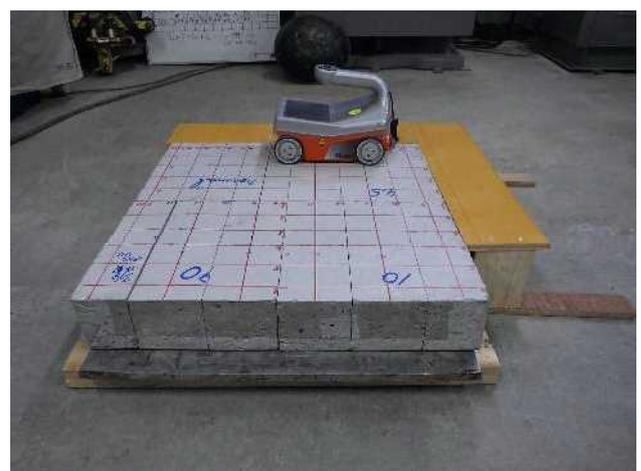
写真-3 測定状況（90mm 下部鉄板有り）
