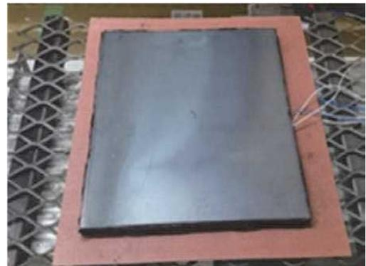
写真-3 シリコンヒータによる加熱状況
