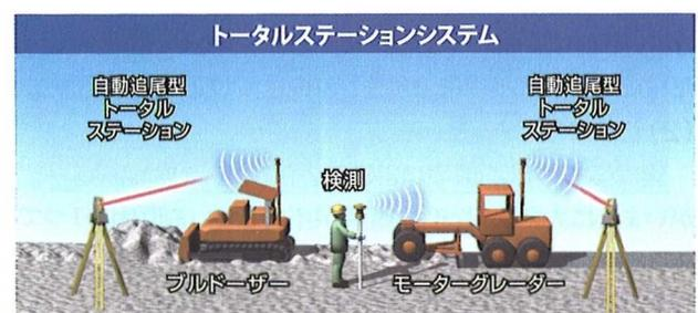
図-3 TSマシンコントロールシステムの概要
