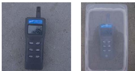
写真-6 CO<sub>2</sub>濃度計と密閉状況
