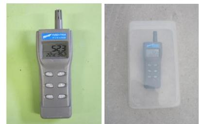
写真-4 CO<sub>2</sub>濃度計と密閉状況
