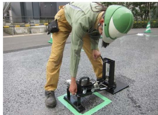
写真-7 ONO・PPSMによるすべり抵抗測定状況
