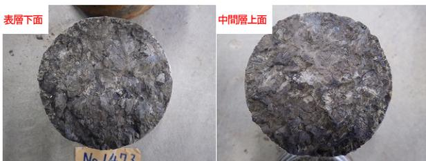
写真-12 No.1473+00(損傷部)の層間界面のはく離状況
