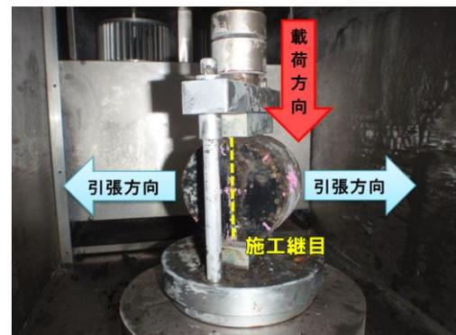
写真-3 圧裂試験状況
