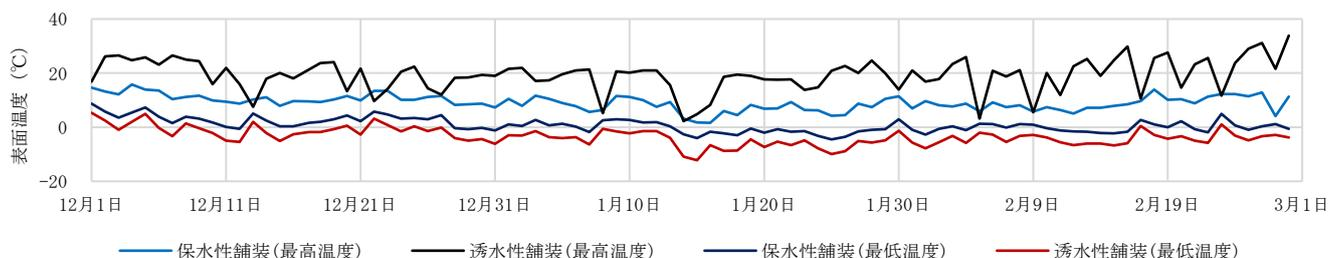
図-4 12月～2月の保水性舗装の温度
