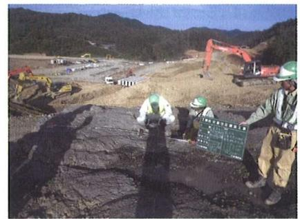
写真-3 簡易弾性波試験の実施状況
