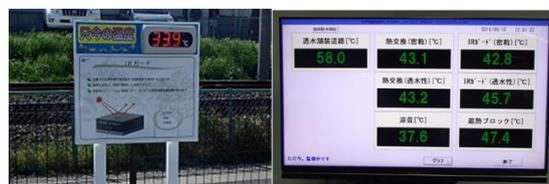
写真-1 路面温度表示モニター（屋外・屋内）
