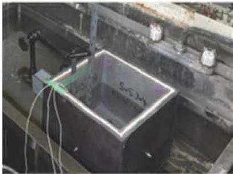
写真-6 箱型の温度測定状況
