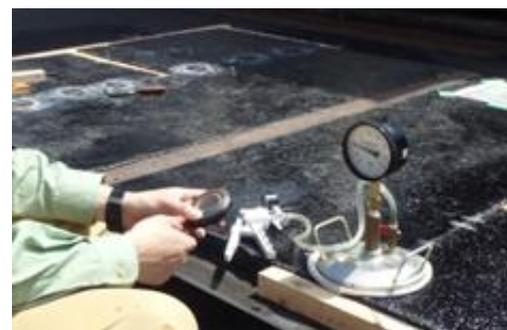
写真-2 真空透気試験状況
