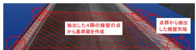
図-3 基準面の作成方法
