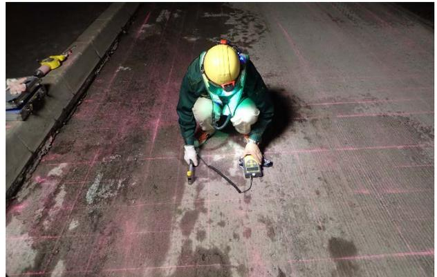
写真-1 コンクリートテストによる床版調査
