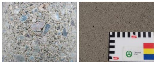
写真-1 新型低炭素舗装断面および表面
