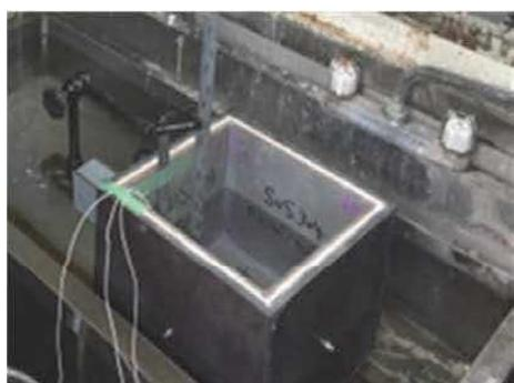
写真-6 箱型の温度測定状況
