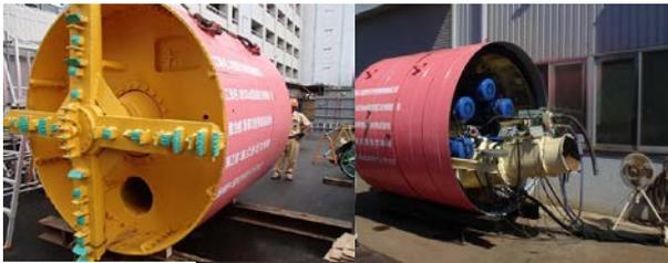
写真-6  $\phi 2000\text{mm}$  泥濃推進機
