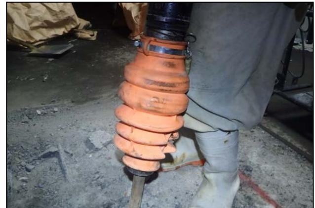
写真-4 ハンドブレーカ用防音カバー装着状態
