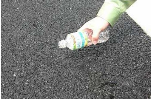
写真-7 水の浸透確認
