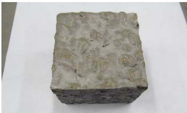
写真-7 半たわみ性舗装供試体
