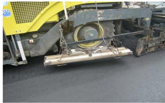
写真-8 ジョイントヒータ設置状況
