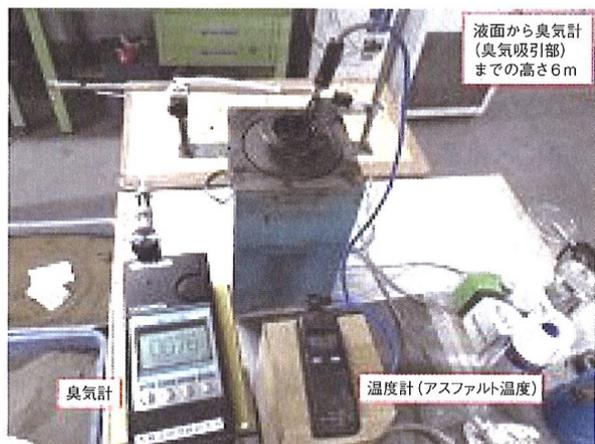
写真-3 臭気試験状況
