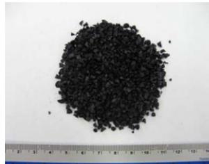
写真-4 表面散布用ゴム粒子
