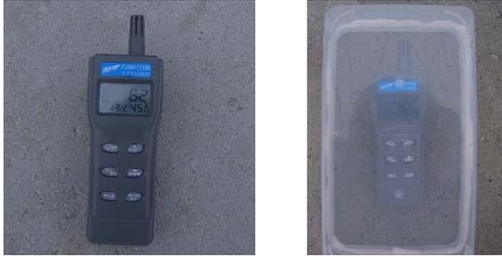
写真-11 CO<sub>2</sub>濃度測定機器(左)、密閉状況(右)
