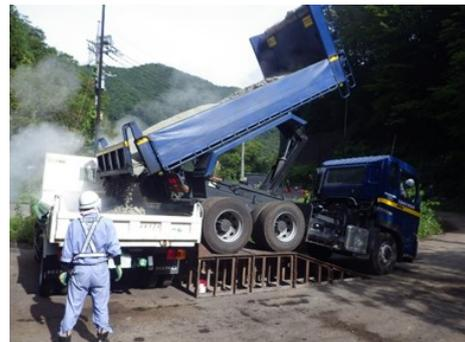
写真-10 4t ダンプへの積替え
