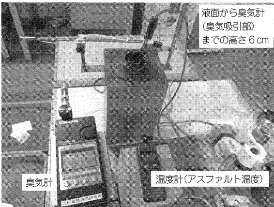
写真-3 臭気試験状況
