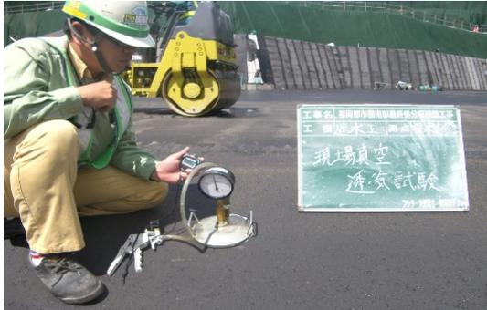
写真-9 真空透気量試験
