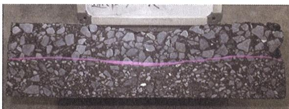
写真-1 試験後の断面 (基層:従来グースアスコン)
