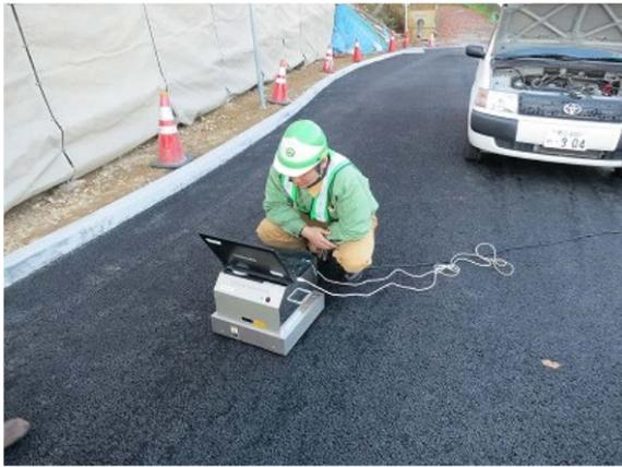
写真-10 CTメータによるきめ深さ測定状況
