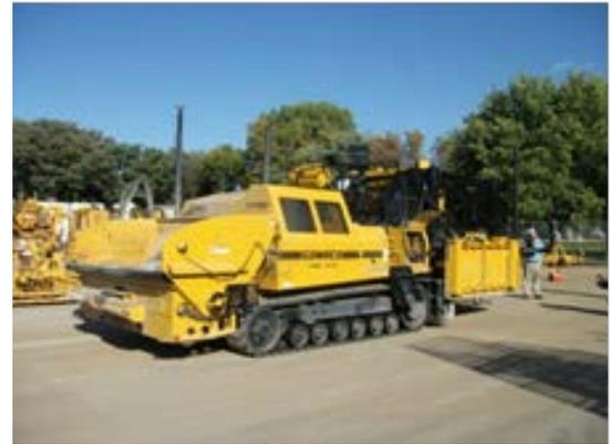
写真-6 多機能プレーシングマシン(RTP-500)
