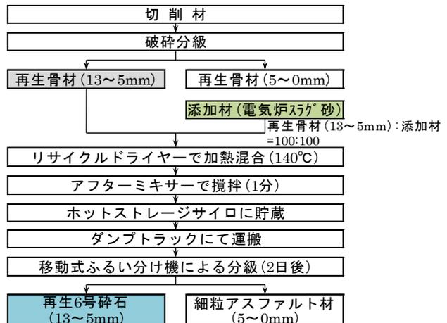
図-2 再生6号碎石の製造の流れ
