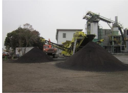
写真-2 移動式ふるい分け機による分級状況
