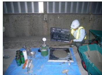
写真-7 スランプ試験後
