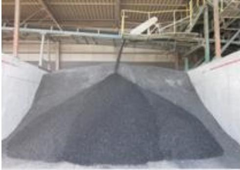
写真-1 一次処理再生骨材のストック状況
