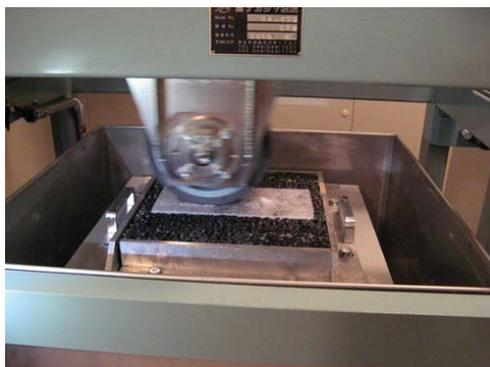
写真-8 氷板 WT 試験状況
