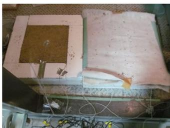
写真-5 室内試験による養生方法の検討状況
