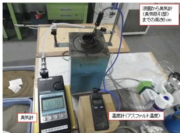
写真-3 臭気試験状況
