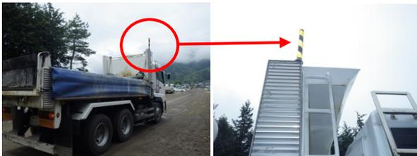
写真-4 衝突防止バーの設置状況
