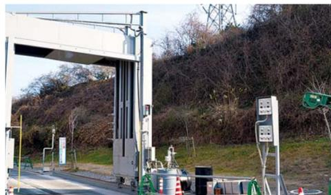
合材付着防止剤の自動散布装置
