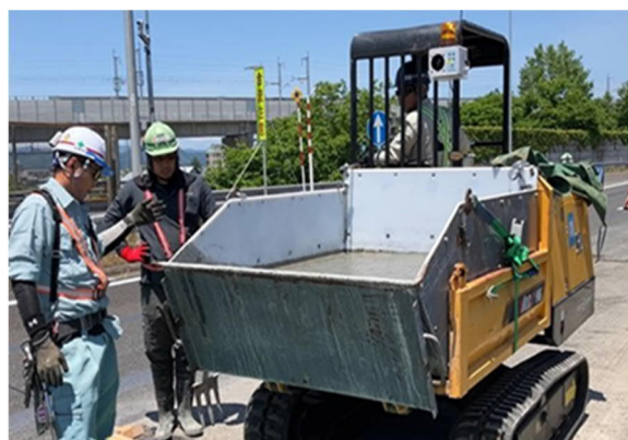
専用キャリアダンプ(運搬状況)
