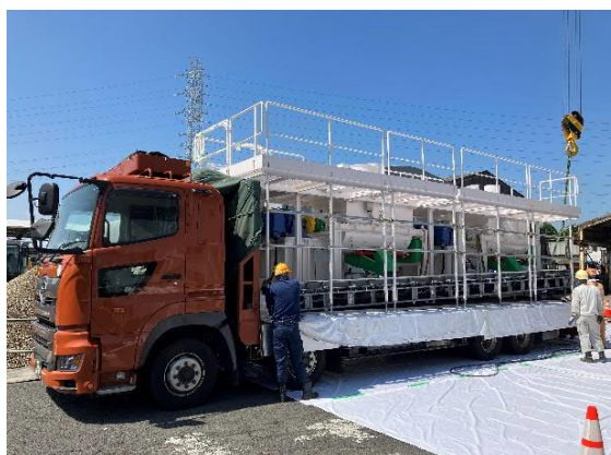
1 車線に収まる新開発の車載型専用プラント
