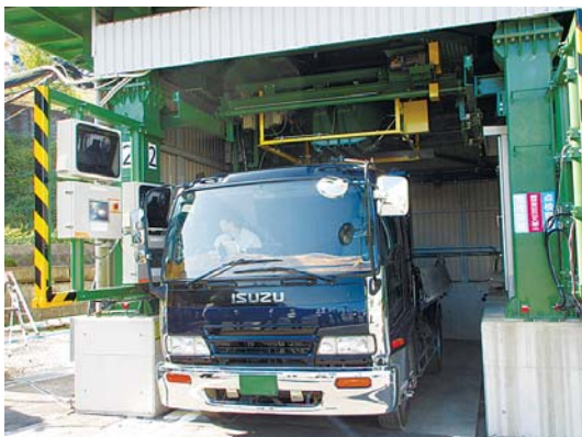
無人化出荷のようす（車両左側の画面は、自動誘導モニター）
