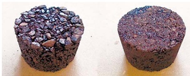
タフアスコン供試体（右）。改質Ⅱ型より優れた耐油性を確認
