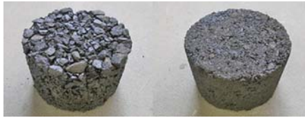
耐油性試験の結果（改質Ⅱ型 （左）とタフアスコン）
