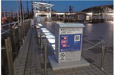
大林道路と早水電機工業（神戸市長田区、藤井純一代表取締役）、宮吉硝子（名古屋市昭和区、立木彰一社長）の3社は太陽光発電で発光する舗装用ガラスユニット「ソーラーウェイ」を開発した。ユニットに組み込んだ発電パネルで昼間に蓄電し、任意の時間に発光できる。ガラスに文字やイラストを印刷すれば夜間の注意喚起や情報発信、イルミネーションに活用可能だ。
