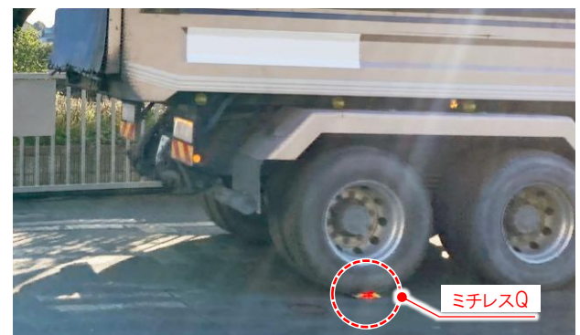
図4 大型ダンブ踏み付け実験
