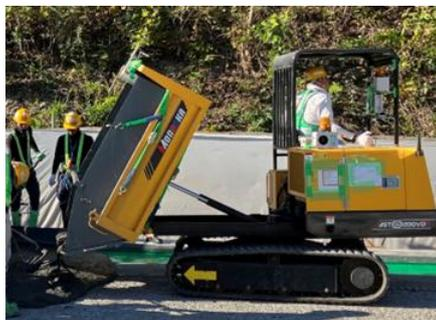
図7 専用キャリアダンプによる運搬・降ろし
