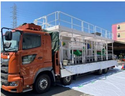
図4 専用の車載式ミキサ
