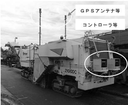
写真-2 mmGPS システムの搭載状況
