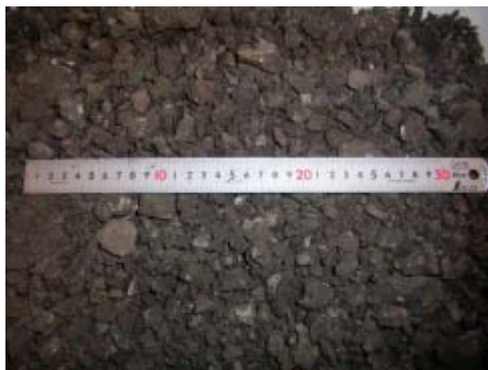
写真-1 表基層混合切削材
