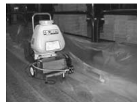
写真-7 送風機の設置 写真-8 消臭噴霧器の設置
