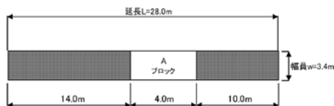
図-2 再試験舗装工区の概要
