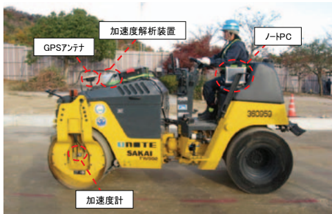
写真-1 振動ローラ (4 トンコンパインドローラ)
