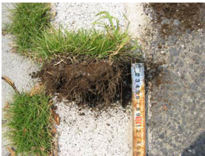
写真-6 下面給水システム無しの場合の根の様子
