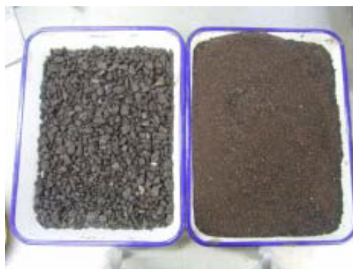
写真-2 分級後の粗骨材・細骨材
