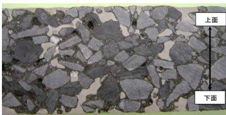
写真-1 セメントミルク充填状況
