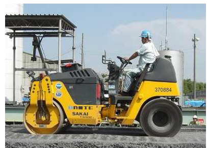
写真-1 4 t コンバインドローラ
