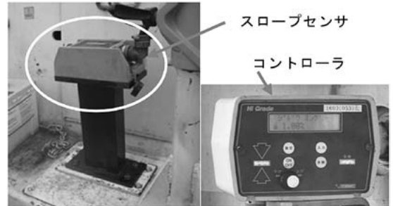
写真-5 スロープセンサの各機材
