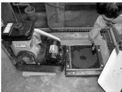
写真-1 室内での細粒材充填確認状況
