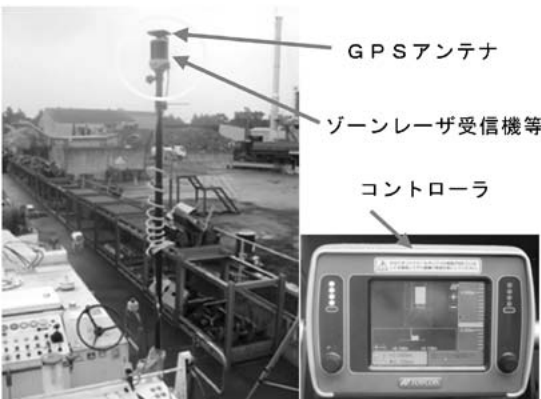
写真-3 mmGPS システムの各機材
