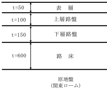
図-6 舗装構成 (単位: mm)
