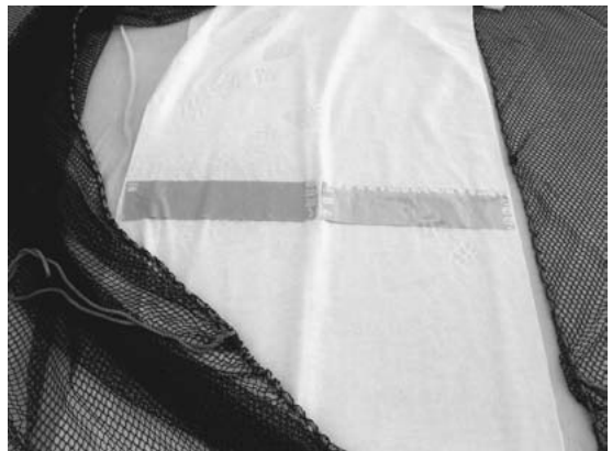
写真-2 吸水変色型養生マット試作品（当初）
