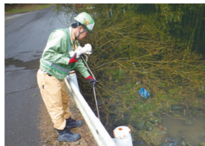
降雨直後の濁度調査で工事による影響を確認
