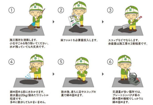
「楽ファルト」の施工方法
