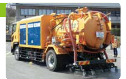
高圧吸引洗浄車での除染作業
