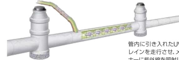
管内に引き入れたUVライトレインを走行させ、メインライナーに紫外線を照射して硬化。
