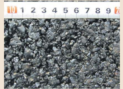
オークサイレントの舗装表面 (ゴム粒子が表面に多量に存在しています)
