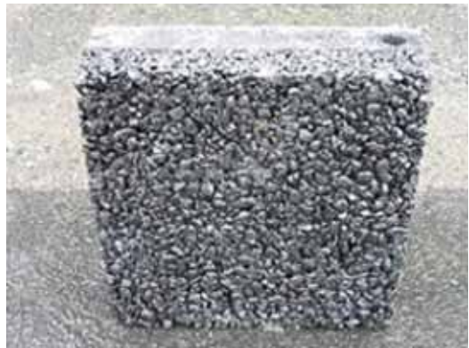
写真-4 基層施工直後に表層を施工した場合の状況
