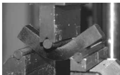
写真-1 バイнда曲げ試験状況
