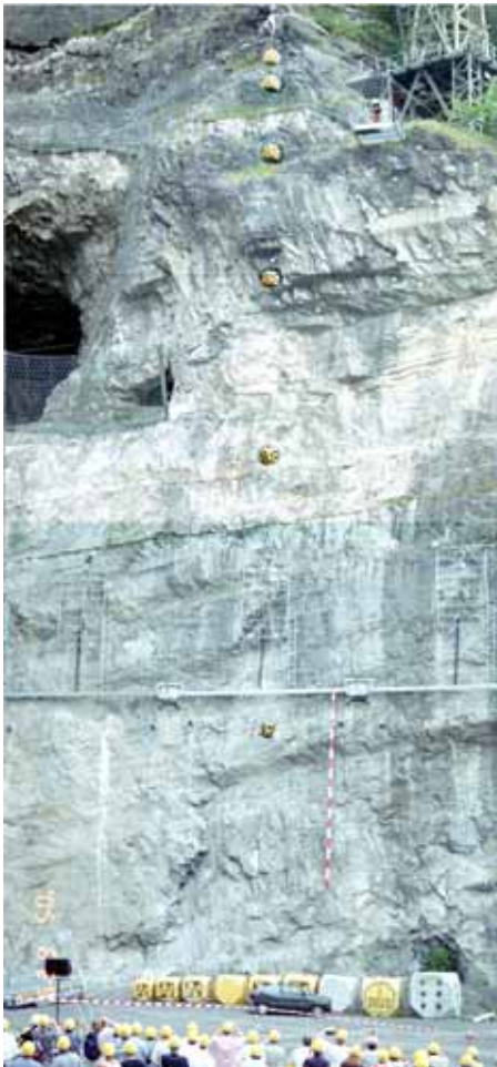
写真-4 落石実験連続写真（落石の軌跡）
