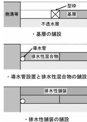
図-1 従来の導水管の施工手順
