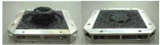
写真-4 (左) 一般高粘度 (右) SFX-HT 排水性混合物 (8) のねじれ抵抗性試験後の供試体
