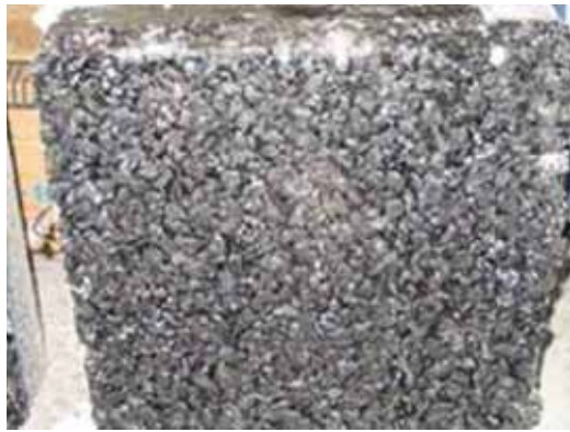
写真-5 車輦走行試験後の供試体状況
