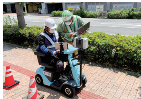
開発中のハンドル型電動車いすを利用した歩道路面評価システム
