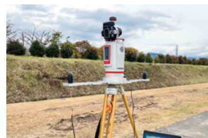
開発したTLSとGNSSを組み合わせた路面凹凸の3次元計測機
