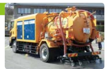
高圧吸引洗浄車での除染作業
