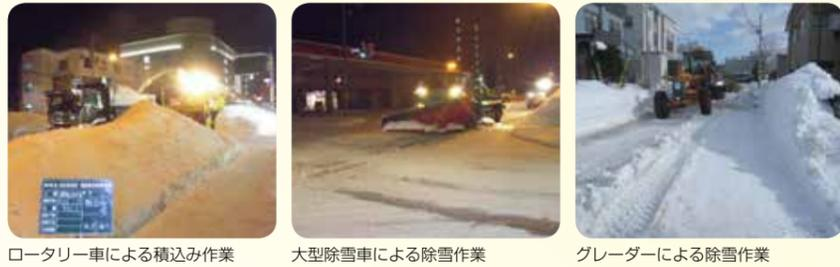
冬期は除雪センターを開設し、モーターグレーダーやタイヤショベルを使用した車道の除雪作業、大型ロータリー車によるダンプトラックへの積雪の積み込み作業、郊外への運搬作業、融雪剤散布車を使用した散布作業を24時間体制で地域住民への対応を行っています。札幌市は、人口約190万人の大都市です。世界的でも人口100万人を超える都市で毎冬約6mの降雪が
