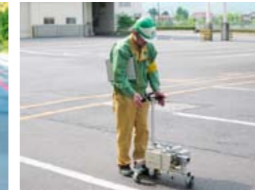
気になる路面の変形をmm単位で測定
