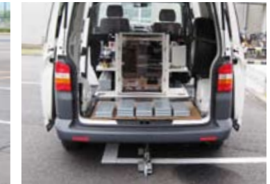
構造的な劣化を非破壊で調査 (FWD 測定車)
