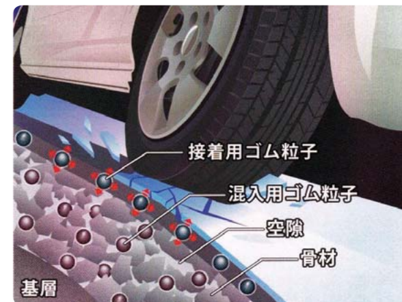
凍結抑制舗装のイメージ
